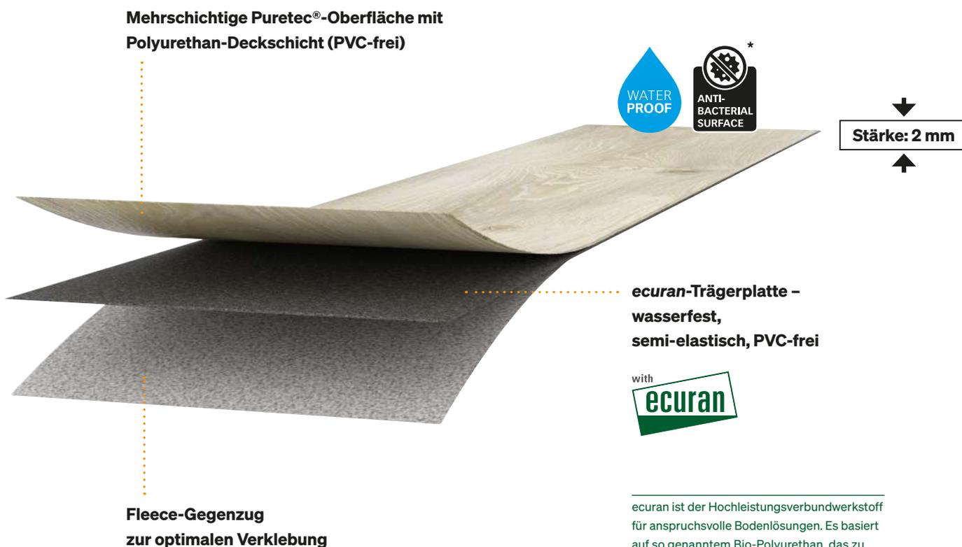
ecuran ist der Hochleistungsverbundwerkstoff für anspruchsvolle Bodenlösungen. Es basiert auf so genanntem Bio-Polyurethan, das zu einem überwiegenden Teil aus Pflanzenölen wie Raps- oder Rizinusöl und natürlich vorkommenden mineralischen Komponenten wie Kreide hergestellt wird. ecuran ist gesundheitlich unbedenklich, denn es verzichtet auf Weichmacher, Lösungsmittel und Chlor.
